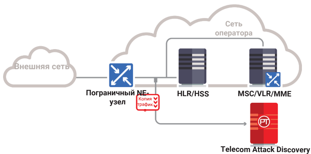
Рисунок 7. Получение трафика от узла агрегации
